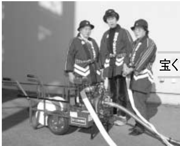
配備された可搬式小型動力ポンプ
