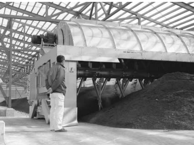
牛ふん系発酵棟。好気性微生物の発酵を促すため、ロータリーかくはん機で3日に1回程度かくはんします
