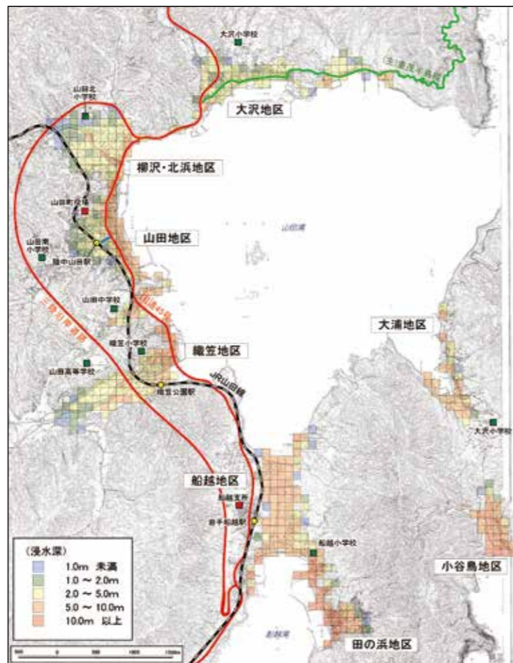
図I-3 津波浸水深分布図 国土交通省都市局「東日本大震災による被災現況調査業務(岩手2)報告書(平成24年3月)」から
