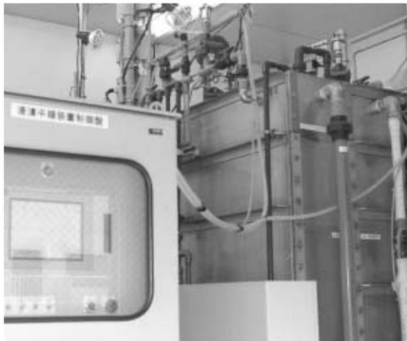
大沢の終末処理場で行われているノロウイルス除去試験装置（生食用カキを生産者が安心して出荷できる浄化方式の確立が求められます）
