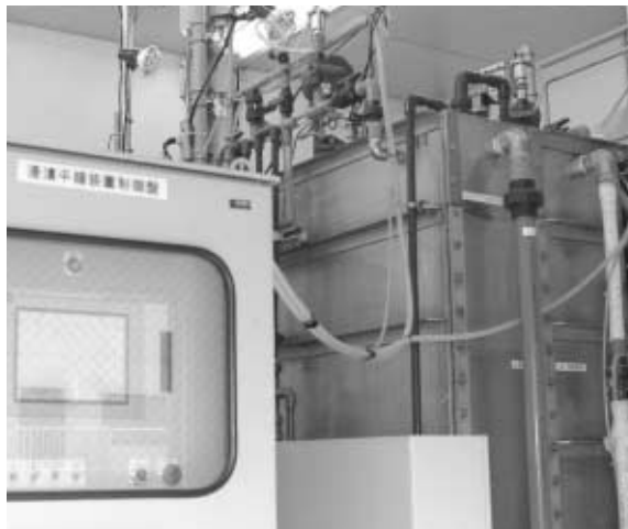
大沢の終末処理場で行われているノロウイルス除去試験装置（生食用カキを生産者が安心して出荷できる浄化方式の確立が求められます）
